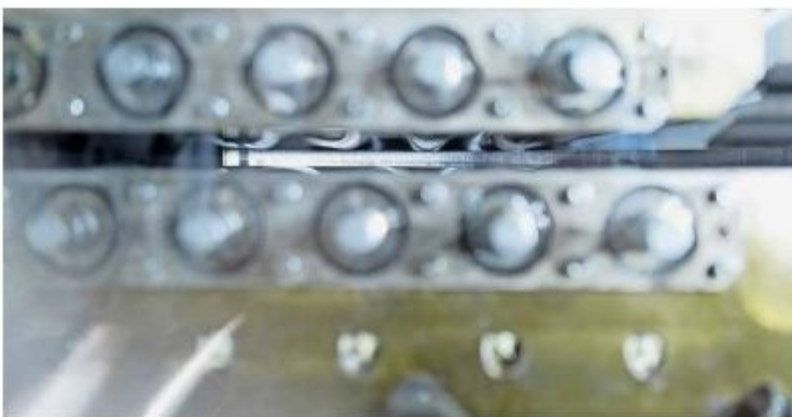
Der FlatMaster beseitigt mit seinen Richtwalzen alle Unebenheiten und nahezu alle Eigenspannungen im Blech.
