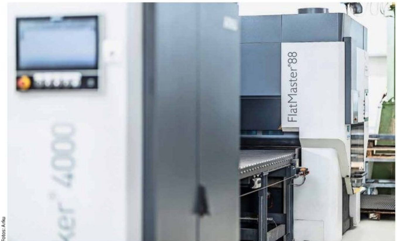
Bei Haller Metall sind zwei unterschiedliche Maschinen sinnvoll verkettet: Eine Entgratanlage EdgeBreaker 4000 und eine Richtmaschine FlatMaster 88.
