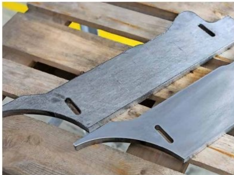
Die Ergebnisse sind eindeutig – ebene Teile mit verrundeten und gratfreien Kanten (r.) sind das, was die Kunden wollen.
