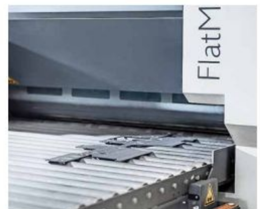
Die Bauteile kommen einbau- oder beschichtungsfertig aus dem FlatMaster.
