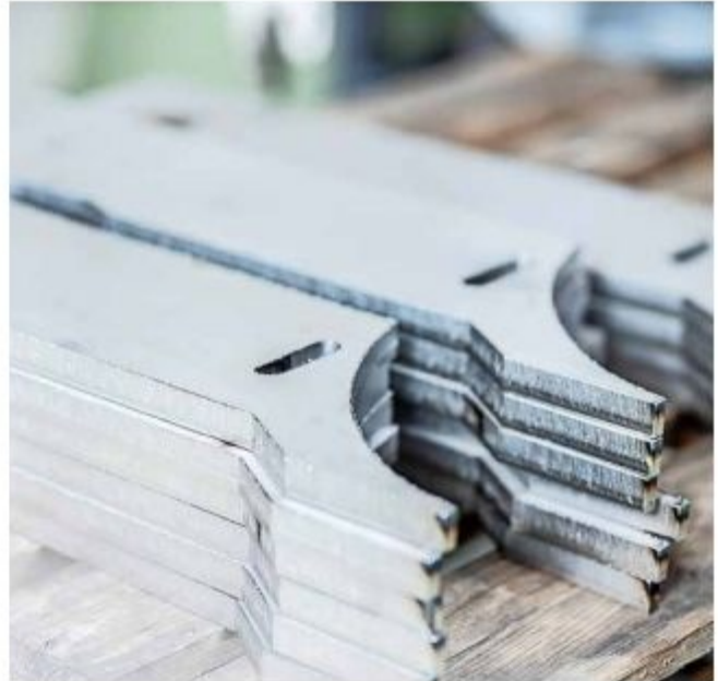
Bei dicken Blechen erzeugt auch das Laserschneiden deutliche Grate. Der EdgeBreaker beseitigt sie zuverlässig.
