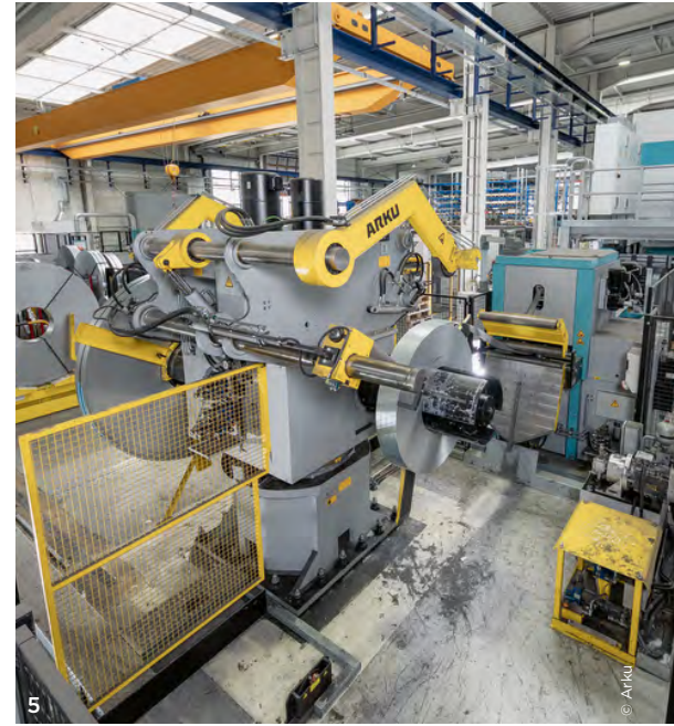
3 Weil es bei dieser Produktionslinie für BITO auf Präzision und Zuverlässigkeit ankommt, steht am Anfang eine ARKU-Bandanlage mit Haspel und Bandrichtmaschine CoilMaster®.
