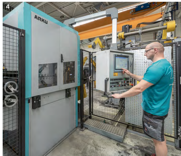
3 Weil es bei dieser Produktionslinie für BITO auf Präzision und Zuverlässigkeit ankommt, steht am Anfang eine ARKU-Bandanlage mit Haspel und Bandrichtmaschine CoilMaster®.
