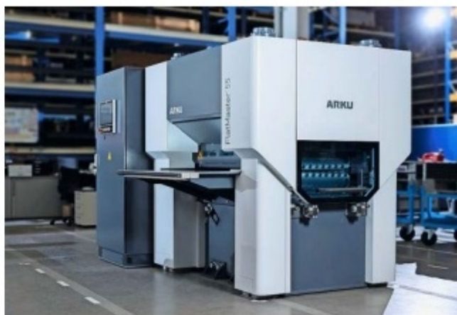
Die Teilerichtmaschine Flat-Master garantiert spannungsarmes Richten von Blechteilen.
