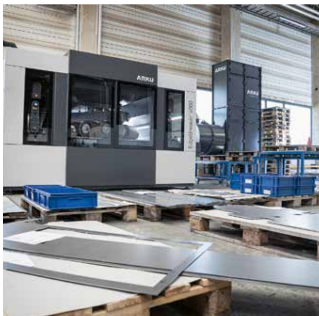
Mit dem Faserlaser aus Großformat-Platinen geschnittene Teile sind ideal zum Entgraten mit dem EdgeBreaker 6000. © Arku Maschinenbau
