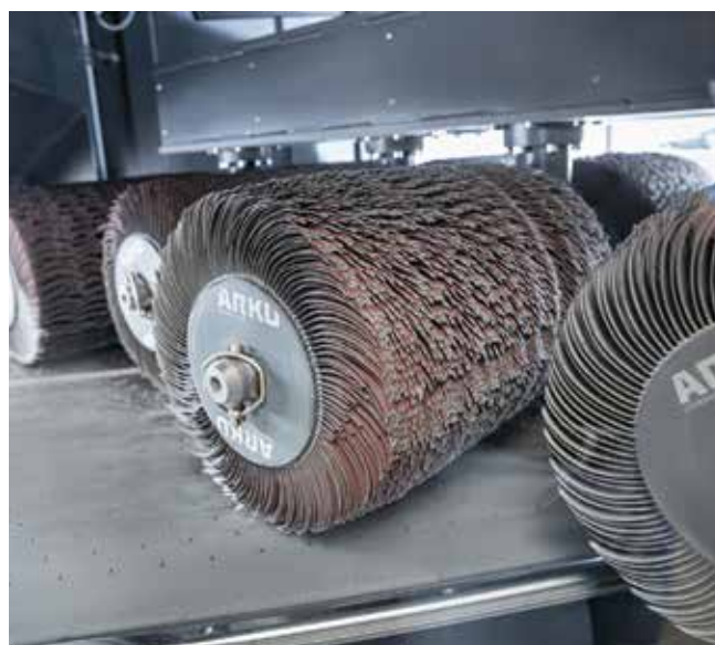
Die rotierenden Bürsten der Entgratmaschine sorgen für eine besonders gleichmäßige Kantenverrundung. © Arku Maschinenbau
