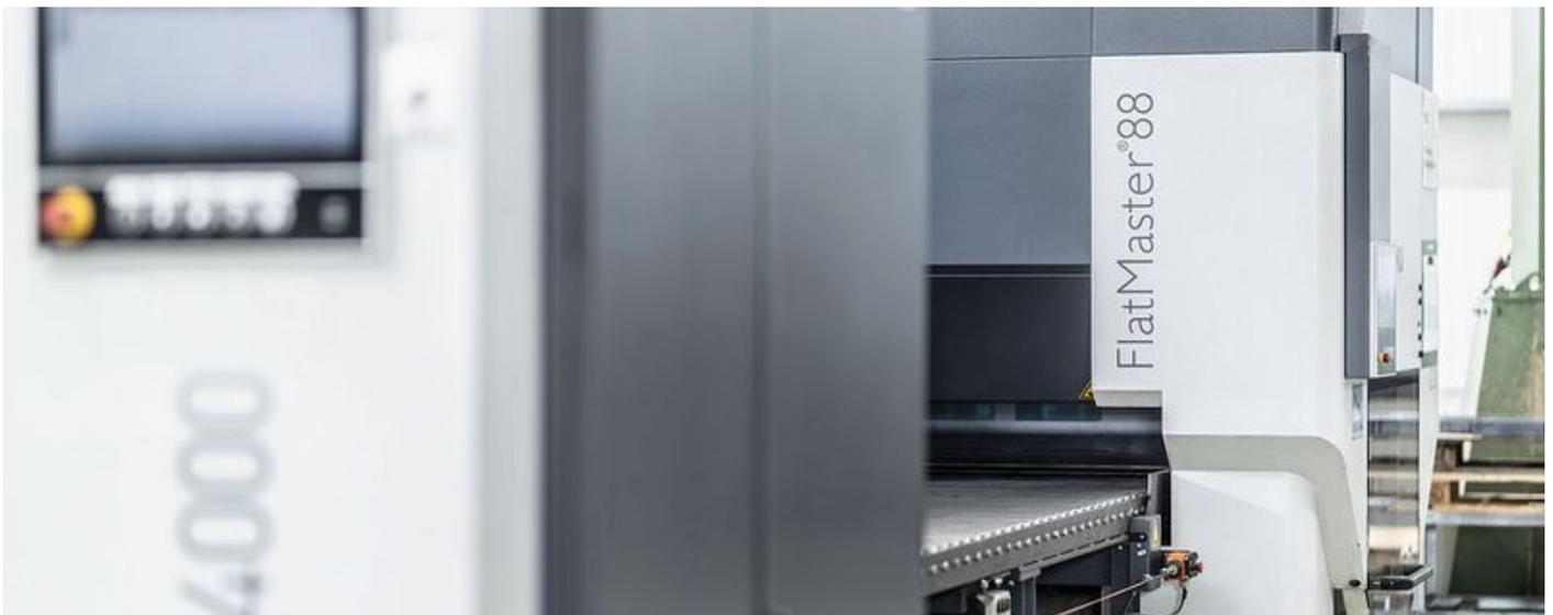
*Bei Hatec sind zwei ganz verschiedene Maschinen sinnvoll verkettet: Eine Entgratanlage Edge Breaker 4000 und eine Richtmaschine Flat Master 88 von Arku.*
