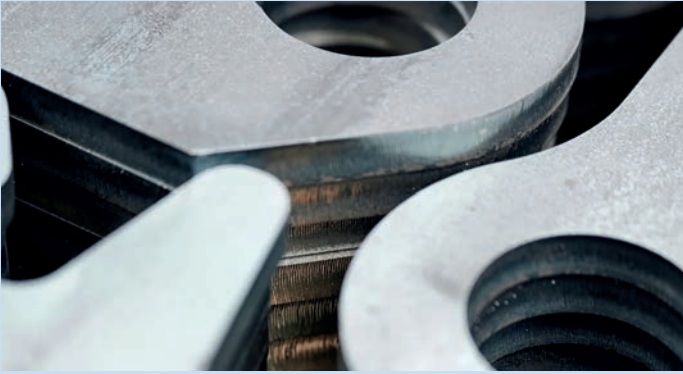
So sehen Blechteile für die präzise Weiterbearbeitung aus: entgratet, verrundet und gerichtet.
