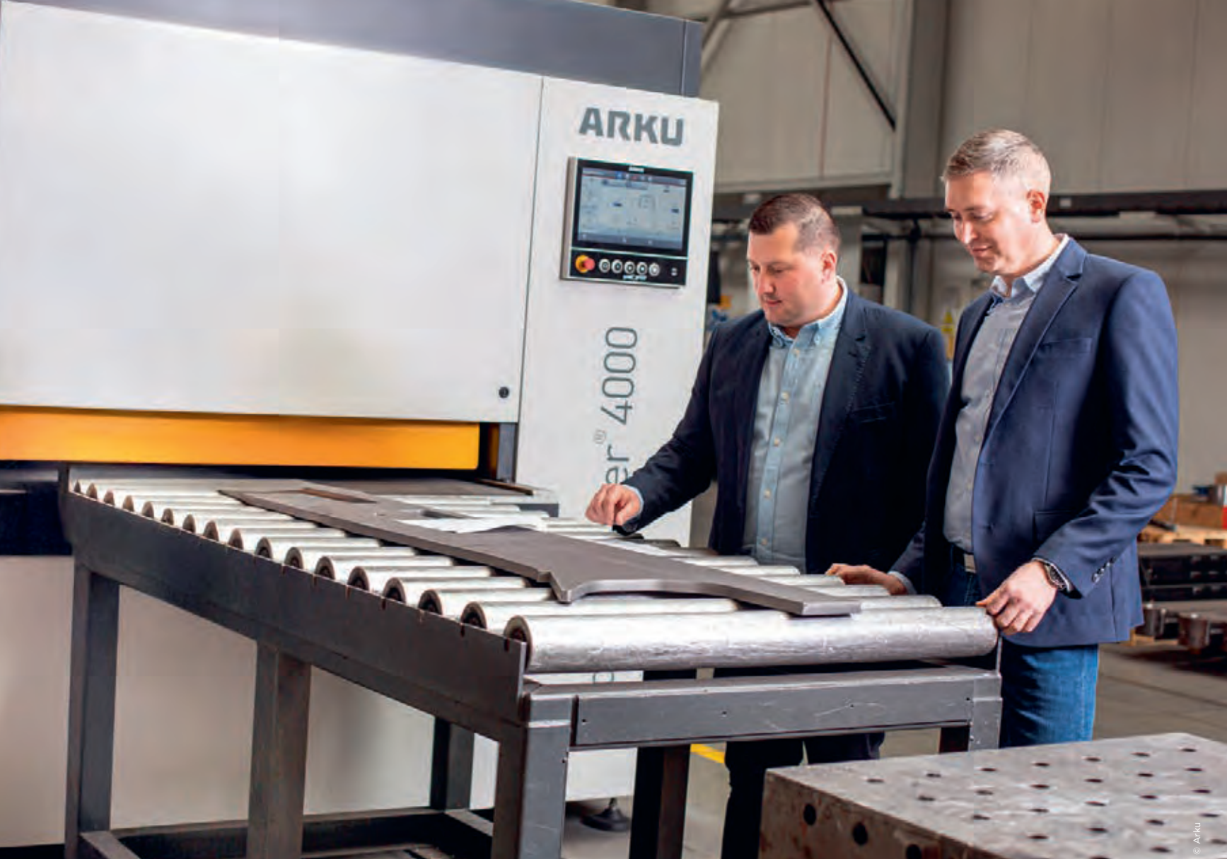
Wie gut sehen die Kanten aus? Witold Matusiak (links), Inhaber von Wit-Metal, und Andrzej Witczak, Leiter Konstruktion und Engineering, prüfen das Entgratergebnis beim EdgeBreaker 4000.
