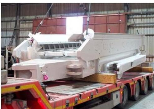
Ein 25 t schweres Fahrgestell für eine Fördermaschine, bereit für den Einsatz in einem kanadischen Bergwerk.
