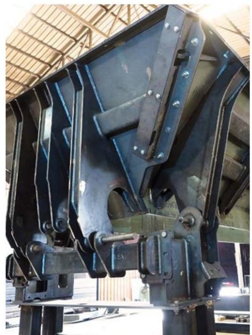
Fahrgestell einer Steinbrechermaschine, gefertigt aus robustem, verschleißfestem Stahl mit einer Härte von 400 HB.
