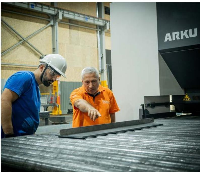
Der FlatMaster-Bediener (in blau) und sein Vorgesetzter (in orange) prüfen das Richtergebnis.
