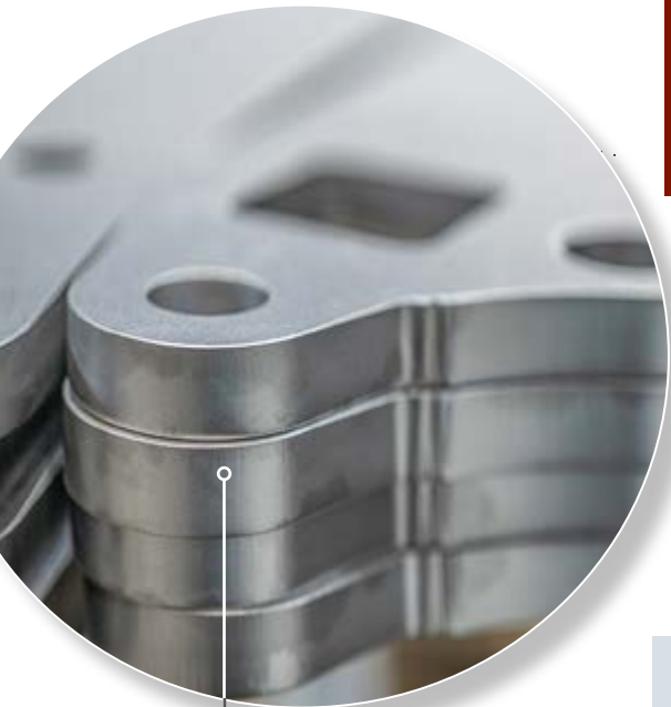
Präzise gerichtet: Die bearbeiteten Teile sind eben und bereit für die nächsten Fertigungsschritte.
