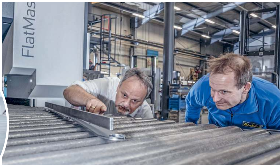
Genauer Blick vor dem ersten Schritt (v.l.n.r.): Thomas Weinfurtner, Vertrieb bei ARKU und Robert Clemens, Mitarbeiter von Einböck prüfen das Blech vor der Bearbeitung und definieren die erforderlichen Richtanforderungen.
