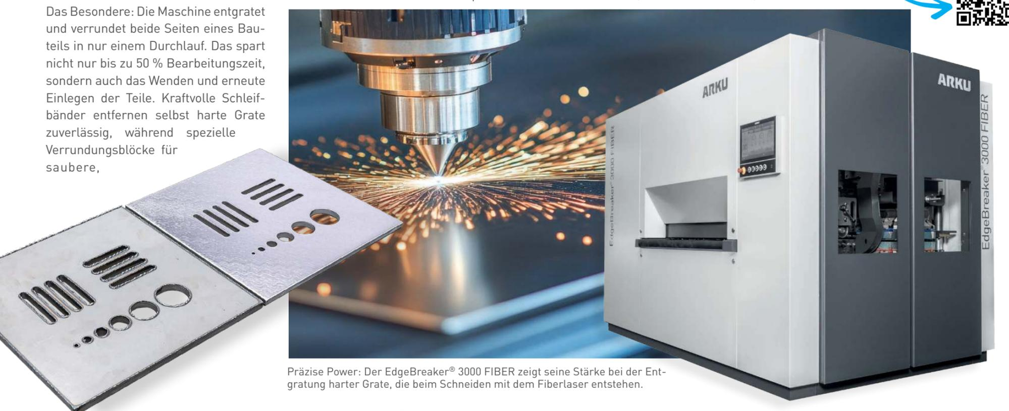
Präzise Power: Der EdgeBreaker® 3000 FIBER zeigt seine Stärke bei der Entgratung harter Grate, die beim Schneiden mit dem Fibrolaser entstehen.
