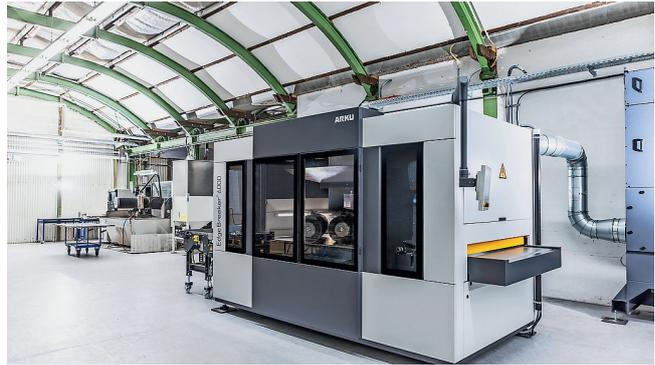
Die Entgratmaschine Edge Breaker 6000 kann entgraten, Blechkanten verrunden und die Oberfläche bearbeiten.
