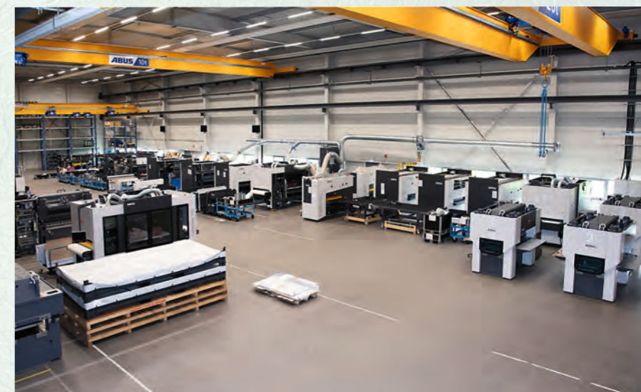
Les nouveaux halls de montage, à Bühl, permettent à Arku de travailler en flux sur les ébavureuses et en îlots pour les planeuses.
