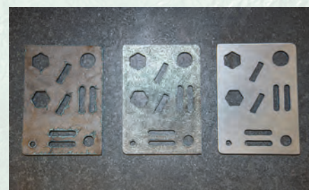
Résultat d'ébavurage après passage sur l'EdgeBreaker 9000 Line. Dans un premier temps, les scories sont supprimées par martelage dans la machine EdgeBreaker 5000, puis les arêtes de la pièce et sa surface sont polies par la machine d'ébavurage EdgeBreaker 4000.
