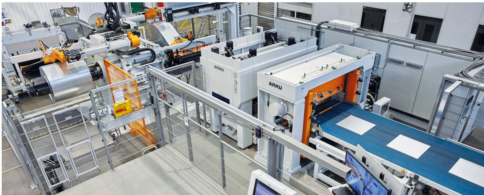
Ein ARKU Kunde aus dem Bereich der Heiz-, Kühl- und Lüftungstechnik benötigte eine Querteilanlage. Sie trägt dazu bei, Blechzuschnitte in hoher Stückzahl platzsparend und fehlerfrei anzufertigen.
