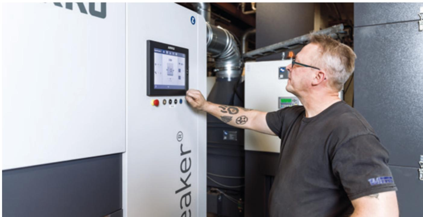
Die Entgratmaschine EdgeBreaker® 4400 wird bei Weland zum ein- und beidseitigen Entgraten und Verrunden von Bauteilen bis zu 100 mm Dicke eingesetzt.
