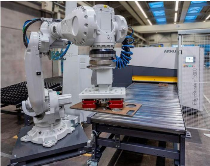
*Das Auge des Vision-Roboters überblickt von oben den Arbeitsbereich und scannt jedes Brennteil. Kleinserien mit variierenden Teilen meistert der Roboter ohne Neuprogrammierung.*
