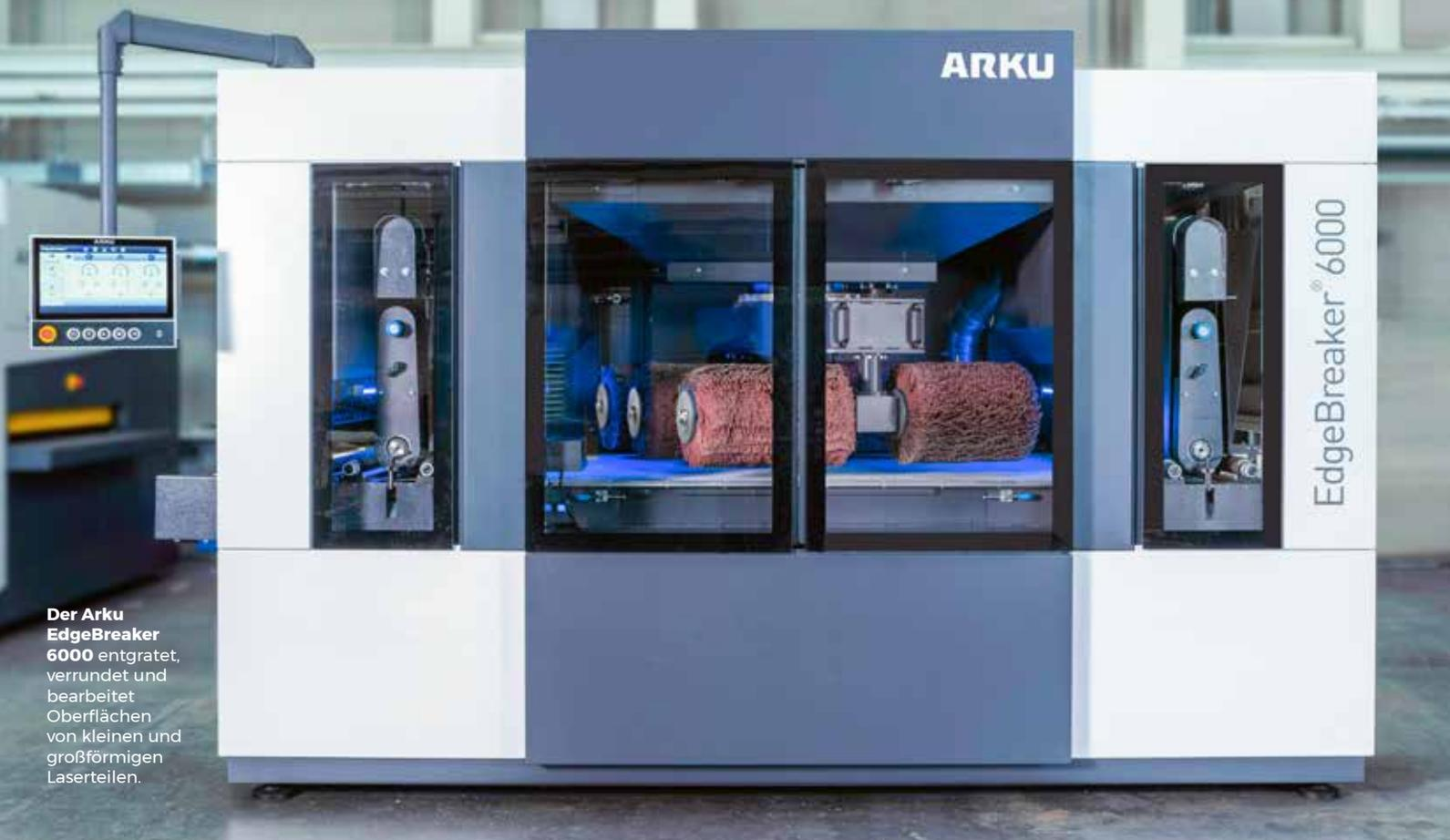
**Der Arku EdgeBreaker 6000** entgratet, verrundet und bearbeitet Oberflächen von kleinen und großförmigen Laserteilen.
