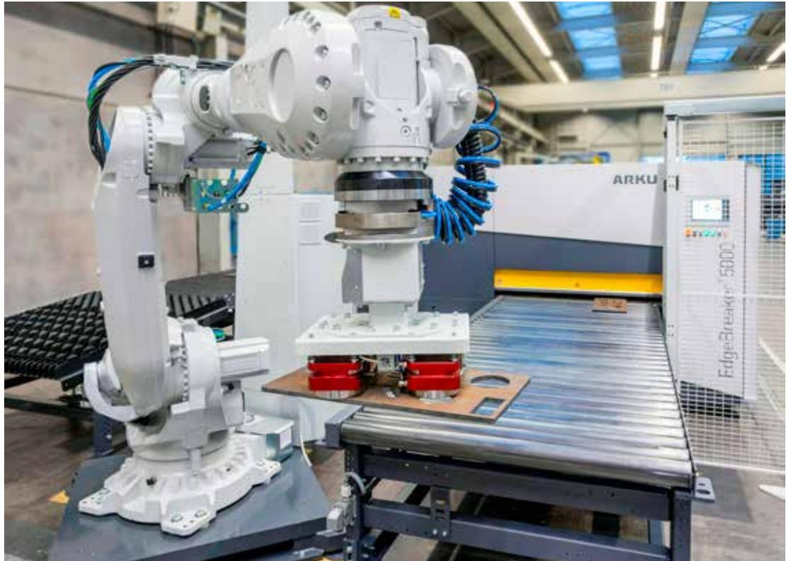
**Das Auge des Vision-Roboters** überblickt von oben den Arbeitsbereich und scannt jedes Brennteil. Kleinserien mit variierenden Teilen meistert der Roboter ohne Neuprogrammierung.
