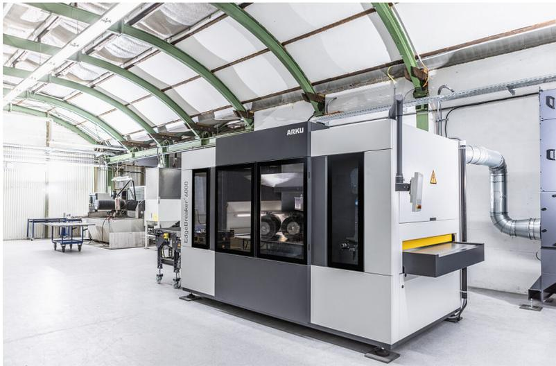
Légende : La machine d'égavurage EdgeBreaker® 6000 peut déjà égavurer, arrondir les bords de la tôle et traiter la surface.
