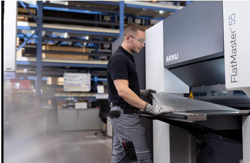
Bildunterschrift: Mit spannungsarmen und ebenen Teilen läuft die Produktion wesentlich besser ab, wie ARKU am Beispiel der Richtmaschine FlatMaster® 55 den Blechexpo-Besuchern erklärt.
