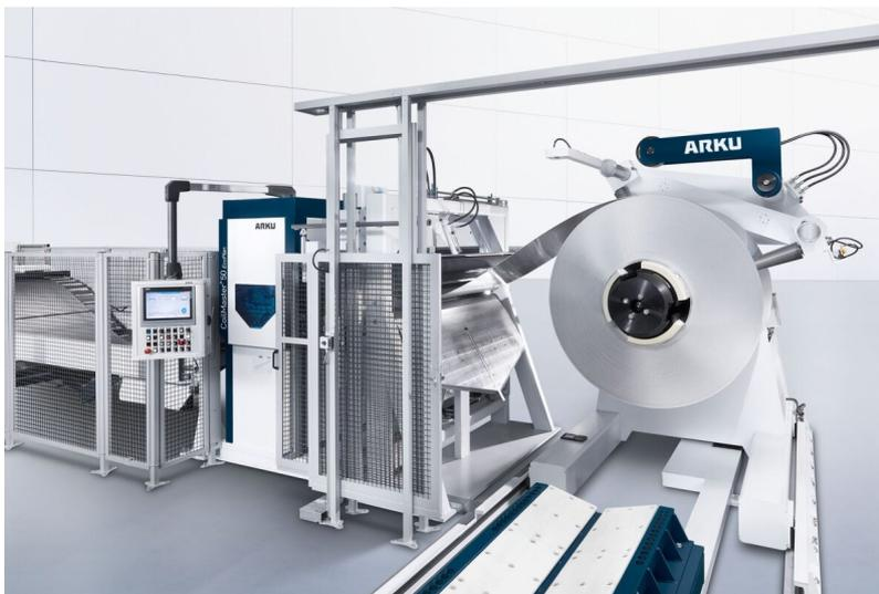
Bildunterschrift: Die Coil-Laser Anlagen haben ARKU und TRUMPF gemeinsam entwickelt. Sie machen das Arbeiten vom Coil auch für mittlere Losgrößen interessant.
