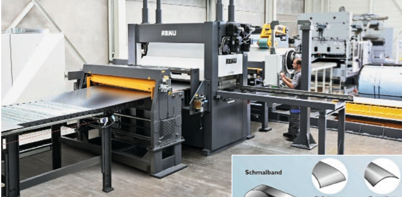
ARKU Querteilanlage mit einer Hochleistungsrichtmaschine HiCap 45
