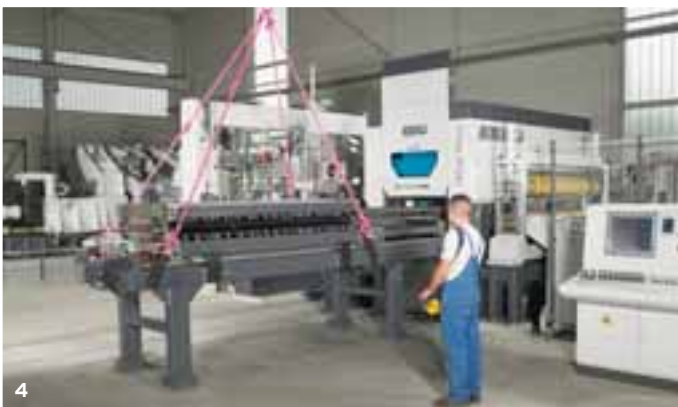
4 _ Kassettenwechsel: Gerade beim Richten hochfester Stahlgüten sinkt der Dickenbereich. HFS hat daher zwei Richtkassetten für unterschiedliche Banddicken. 5 _ Die Maschinensteuerung der Arku-Richtmaschine zeigt jederzeit übersichtlich die Lage in der Produktion.
