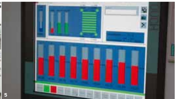
4 _ Kassettenwechsel: Gerade beim Richten hochfester Stahlgüten sinkt der Dickenbereich. HFS hat daher zwei Richtkassetten für unterschiedliche Banddicken. 5 _ Die Maschinensteuerung der Arku-Richtmaschine zeigt jederzeit übersichtlich die Lage in der Produktion.
