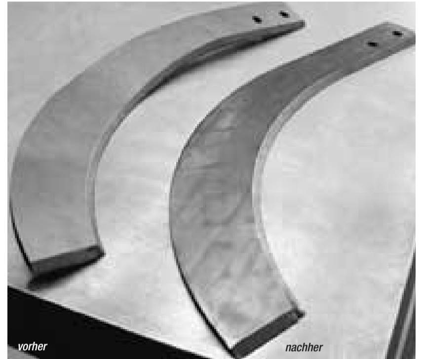
Unten: Ebene Brennteile – Vorher-Nachher Vergleich von Richtversuchen im ARKU Richtzentrum in Baden-Baden.
