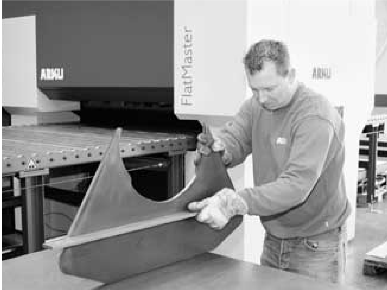
Links: Die hydraulische Teilerichtmaschine FlatMaster® sorgt für gute Richtergebnisse bei allen Blechteilen bis 50 mm.
