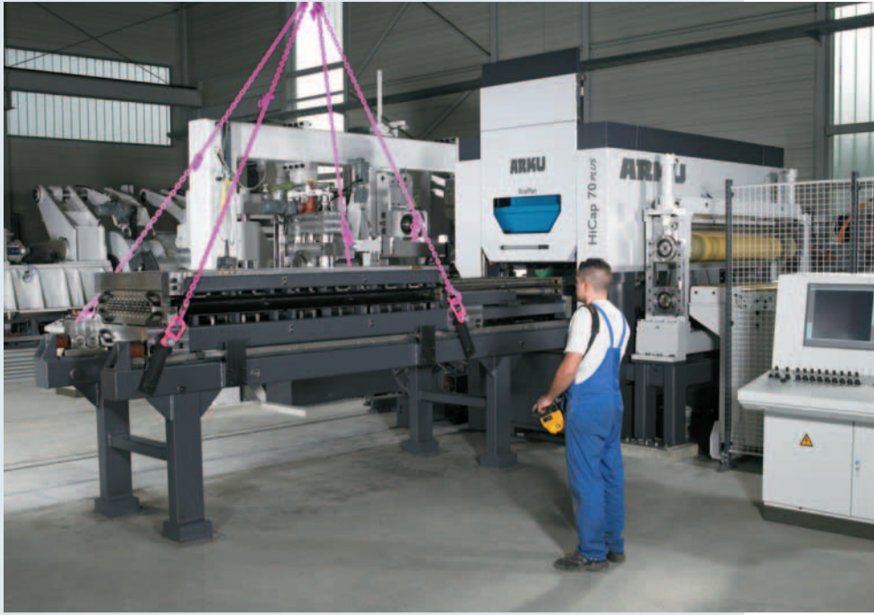
Die ARKU HiCap® PLUS - ausgerüstet mit einem Kassettenwechselsystem für unterschiedliche Walzendurchmesser
