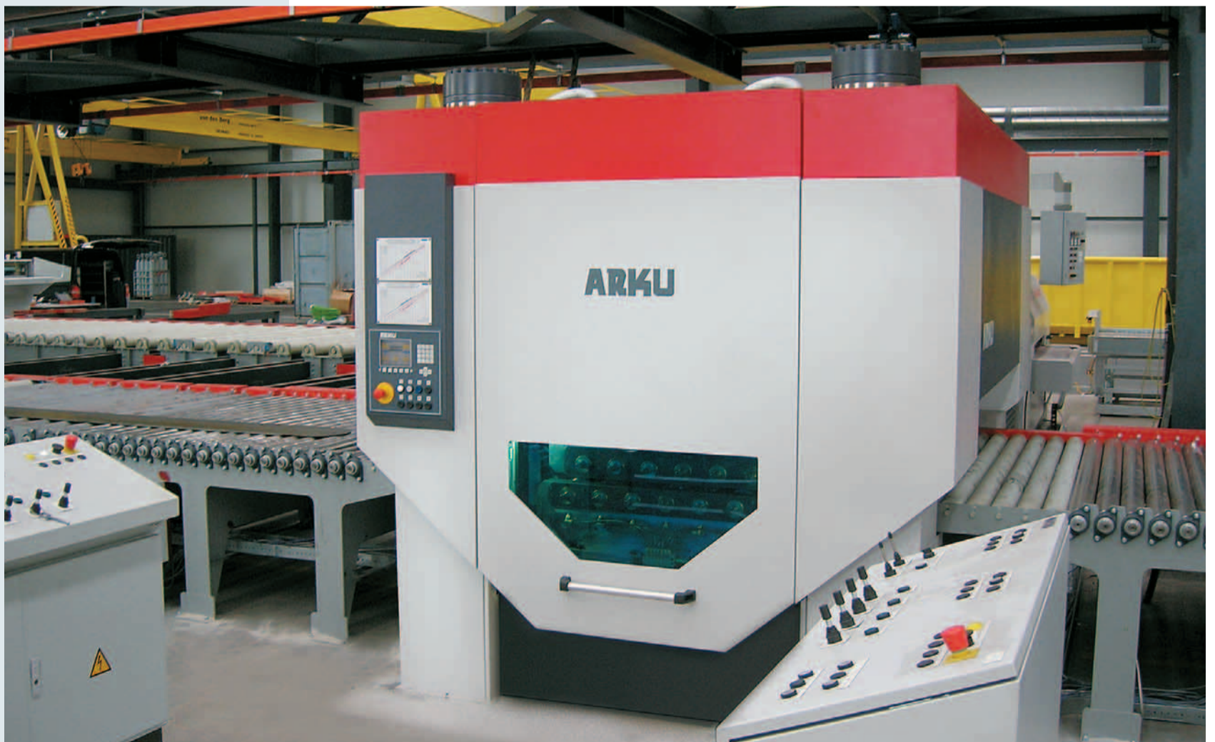
In Linie – über Rollenbahnen ist der FlatMaster® bei Europe Steel Center in eine komplette Schneidanlage integriert
